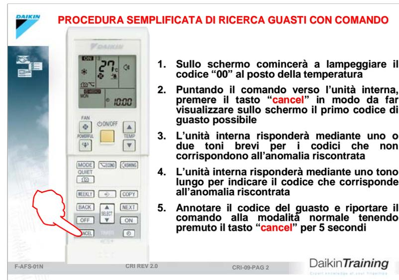
I comandi di ultima generazione, oltre alla procedura convenzionale precedentemente descritta, sono dotati di una modalità semplificata di ricerca del guasto, basata sull'utilizzo di un unico tasto. La procedura permette di visualizzare in sequenza solo i vari codici "attivi" per il modello considerato.
